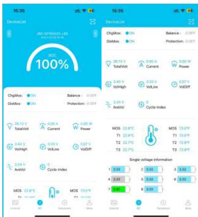
Показания состояния литиевого аккумулятора в мобильном приложении Smart BMS (подключение по Bluetooth)
